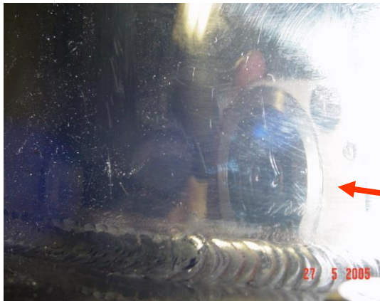
Corrosão intergranular próxima à solda de aço 304
