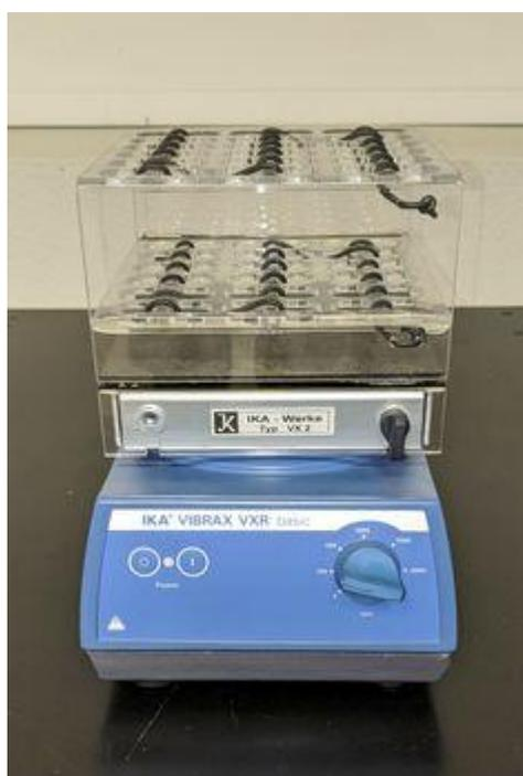
Sistema para agitar as amostras (Vibrax). Os tubos são suportados por essa base de acrílico. A agitação é do tipo "orbital" e você controla a rpm.
