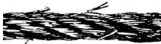
Falha por fadiga após flexão em torno de polia pequena
