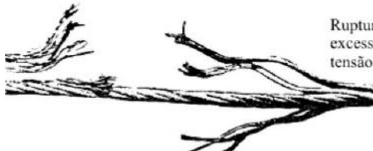
Ruptura por excesso de tensão
