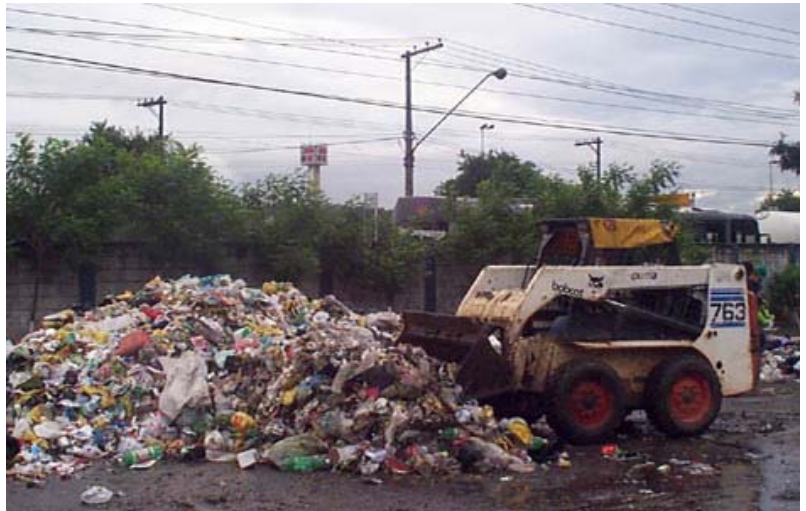
Foto 6 – Bobcat revolvendo o lixo até a homogeneização
