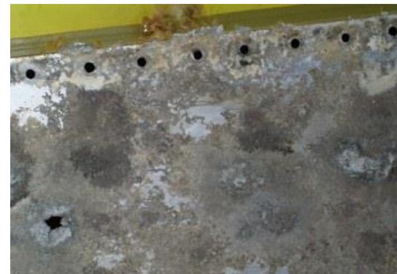
Corrosão em frestas em painel onde chapas plásticas foram colocadas sobre aço zincado.
