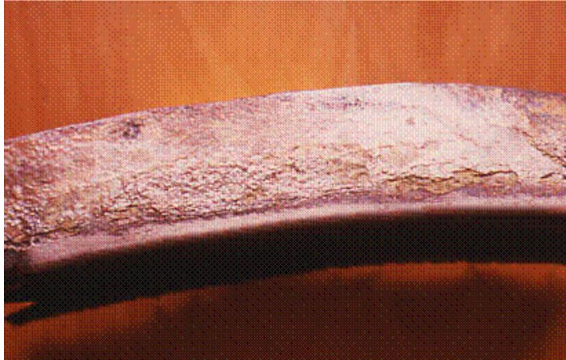
Corrosão em fresta formada numa flange de titânio com uma gaixeta de borracha, em pH baixo e na presença de cloretos
