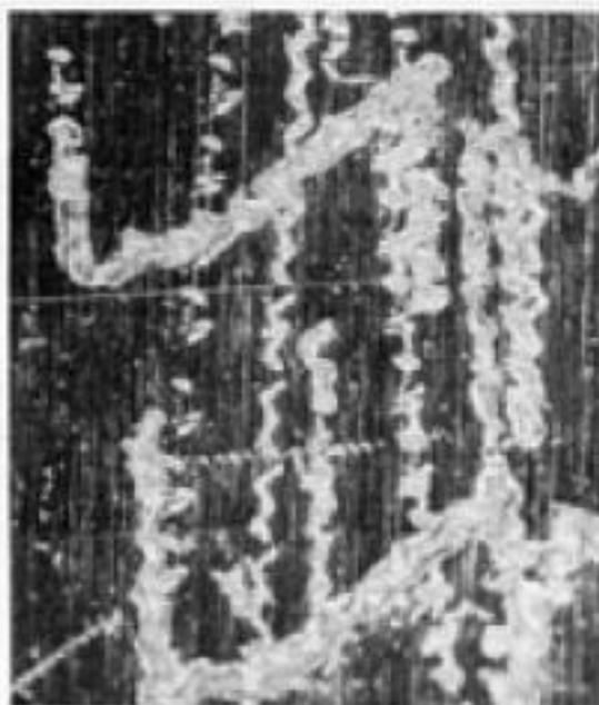
Corrosão filiforme sob verniz de nitrocelulose aplicado sobre folha de Al . A corrosão seguiu a direção de laminação e o desenho estampado
