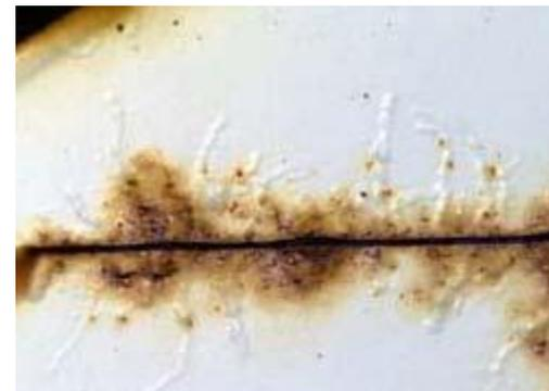
A corrosão ocorre pela diferença na concentração de  $\text{O}_2$  na cabeça e na cauda do “túnel”. Formam-se produtos de corrosão sob o revestimento. Isso ocorre em revestimento com fraca aderência. Em vernizes transparentes, há perda estética.
