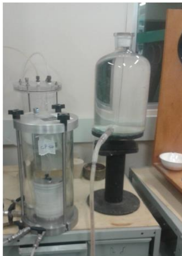
Figura 4-15 – Frasco de Mariotte preenchido com água ao lado de corpo-de-prova em câmara do aparelho Tri-Flex.
