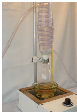
Figura 1: Montagem da aparelhagem.
