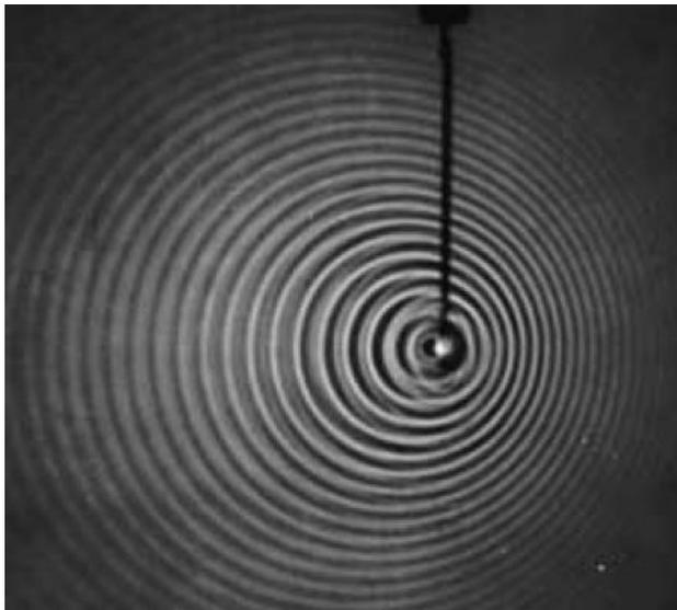
Efeito Doppler na água, com fonte se movendo para a direita com velocidade  $v$
