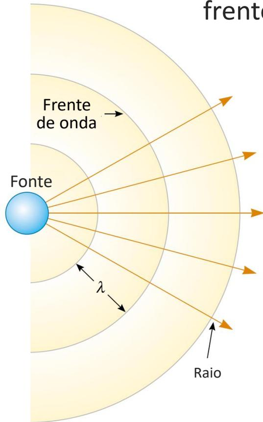
Uma pequena porção da frente de onda, longe da fonte, mostra que os raios que passam através da frente de onda são quase paralelos entre si, e a frente de onda é quase planar.
