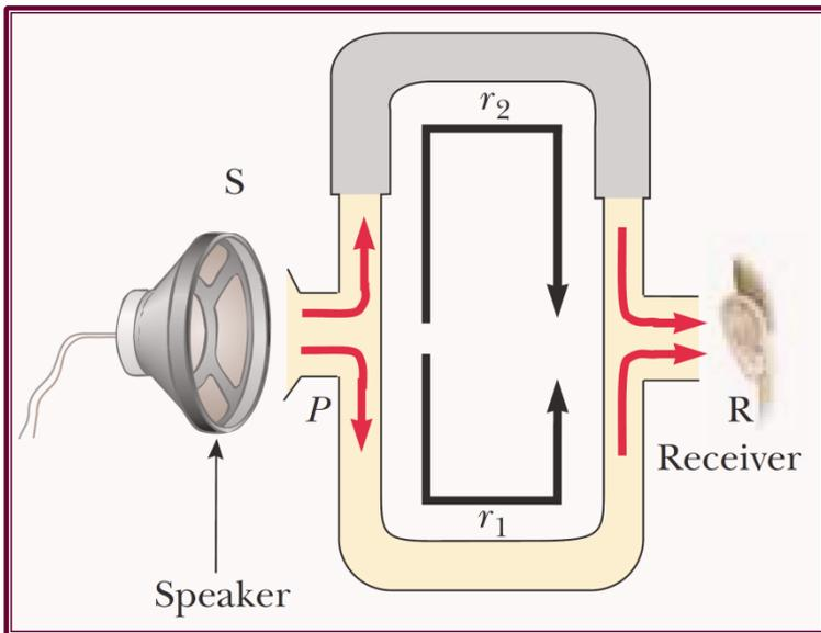
Se  $r_2$  é ajustado tal que  $\Delta r = n\lambda/2$  ( $n$  ímpar), as duas ondas estarão defasadas exatamente de  $\pi$ , interagindo destrutivamente, e nenhum som é detectado em R. Esta experiência demonstra que a diferença de fase entre duas ondas pode existir, mesmo que elas tenham sido geradas pela mesma fonte, quando elas se propagam através de caminhos de comprimentos diferentes.
