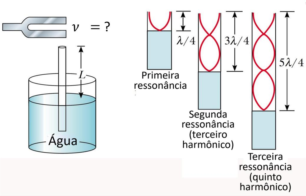
Apesar de a extremidade do tubo, submersa na água, ser aberta, para deixar a água entrar, a superfície da água atua como uma parede e este aparato representa um tubo fechado em uma das extremidades. Assim, a frequência fundamental é
