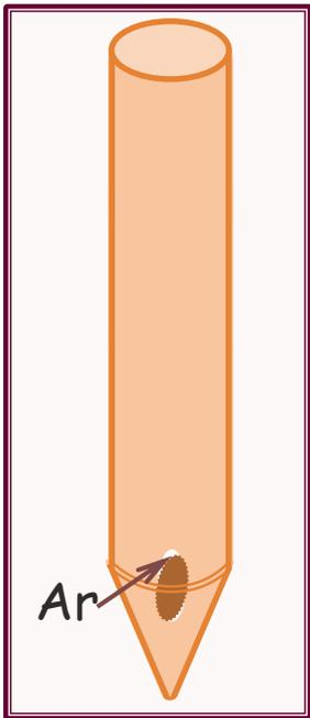
Vamos tomar um tubo cilíndrico aberto na sua extremidade, como um tubo de órgão, onde o ar soprado, através dos foles, produz a excitação da onda sonora. A entrada do ar pela abertura do tubo gera um antinodo (máximo) da onda de deslocamento. O tipo de onda estacionária que será gerada depende de a outra extremidade do tubo estar fechada ou aberta.
