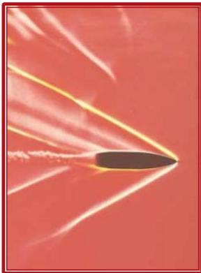
Fotografia estroboscópica de uma bala movendo-se com velocidade supersônica através do ar quente acima de uma vela, onde observa-se a onda de choque nas proximidades da bala.
