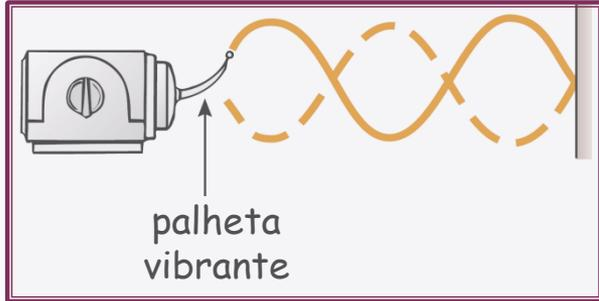
Quando a frequência da palheta vibrante é igual a uma das frequências naturais da onda da corda, ondas estacionárias são produzidas e a corda oscila com uma grande amplitude. No caso da ressonância mostrada na figura, a onda gerada está em fase com a onda refletida e a corda absorve energia da palheta. Se a frequência da palheta não é igual à de um dos modos naturais da corda, então as oscilações têm pequena amplitude e exibem um perfil não estável.
