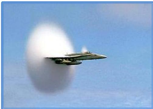
Quando o ar em fluxo supersônico é comprimido, sua pressão e densidade aumentam, formando uma onda de choque. Em vôo supersônico (com velocidades acima de Mach 1), o avião produz inúmeras ondas de choque, sendo mais intensas as que se originam no nariz do avião, nas partes dianteira e posterior das asas e na parte terminal da fuselagem.
