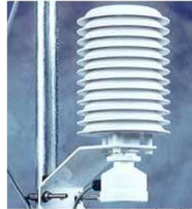
Abrigo meteorológico utilizado em estações meteorológicas automáticas
