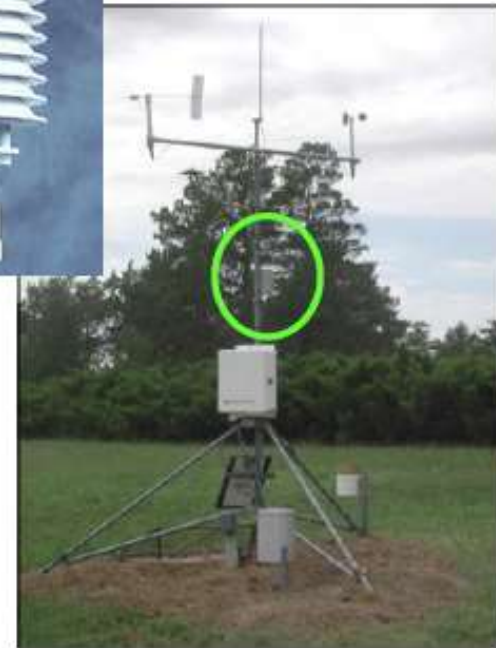
Abrigo meteorológico utilizado em estações meteorológicas automáticas
