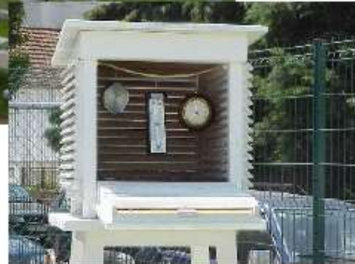
Abrigos meteorológicos utilizados em estações meteorológicas convencionais
