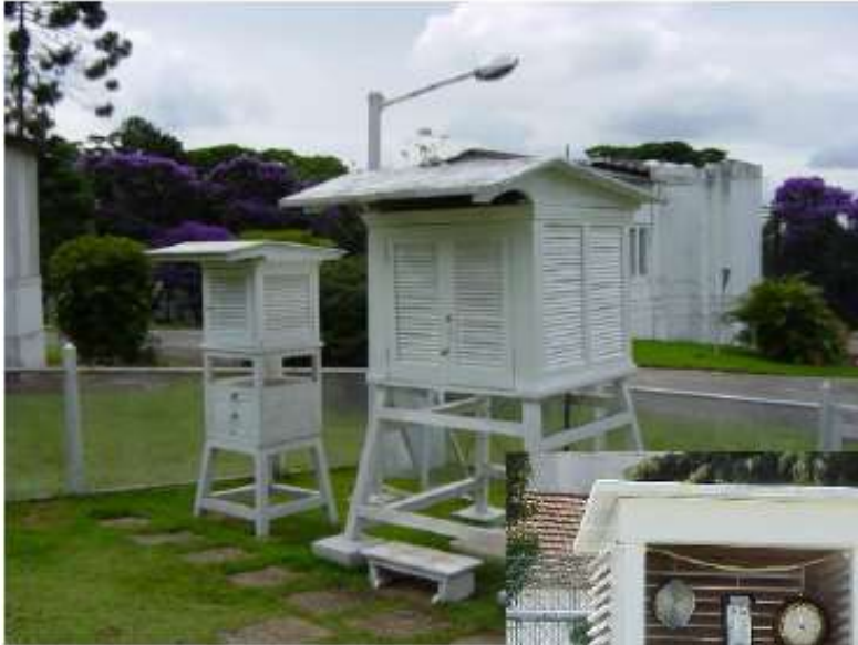
Abrigos meteorológicos utilizados em estações meteorológicas convencionais
