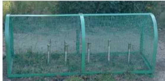
Geotermômetros instalados em solo desnudo
