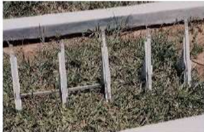
Geotermômetros instalados em gramado
