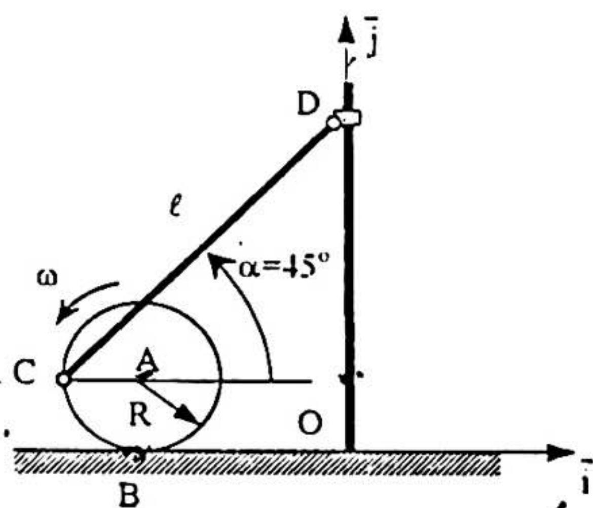
Questão 2 (3,5 pontos). O disco de centro A e raio R rola sem escorregar sobre um plano horizontal com velocidade angular constante  $\omega$ . A barra CD, de comprimento  $l$ , é articulada em C e D. A luva em D pode deslizar ao longo da guia vertical. Na situação indicada na figura ( $\alpha = 45^\circ$ ), pede-se:
