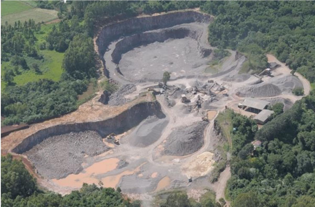
Agregados naturais: extração de rochas, britagem e peneiramento. finos residuais são gerados
