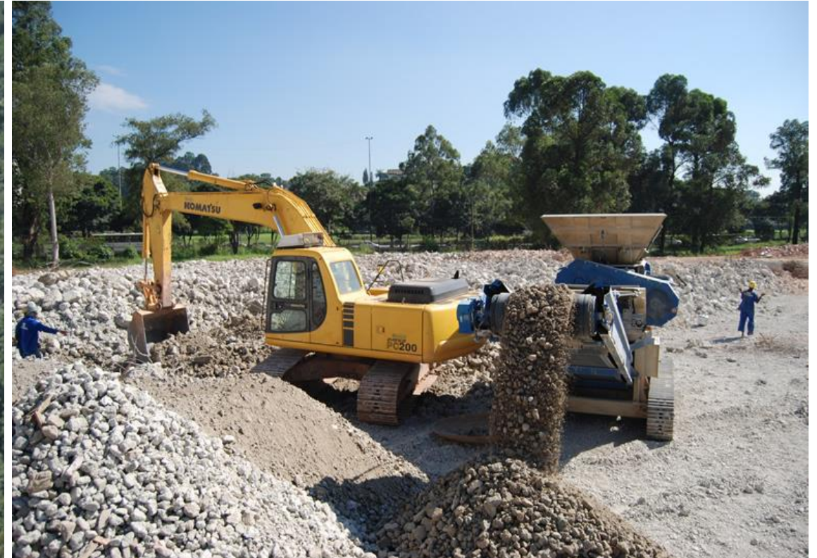
Agregados reciclados de resíduos de construção: seleção, triagem, britagem, peneiramento
