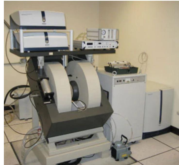
**Espectrômetro de EPR**
