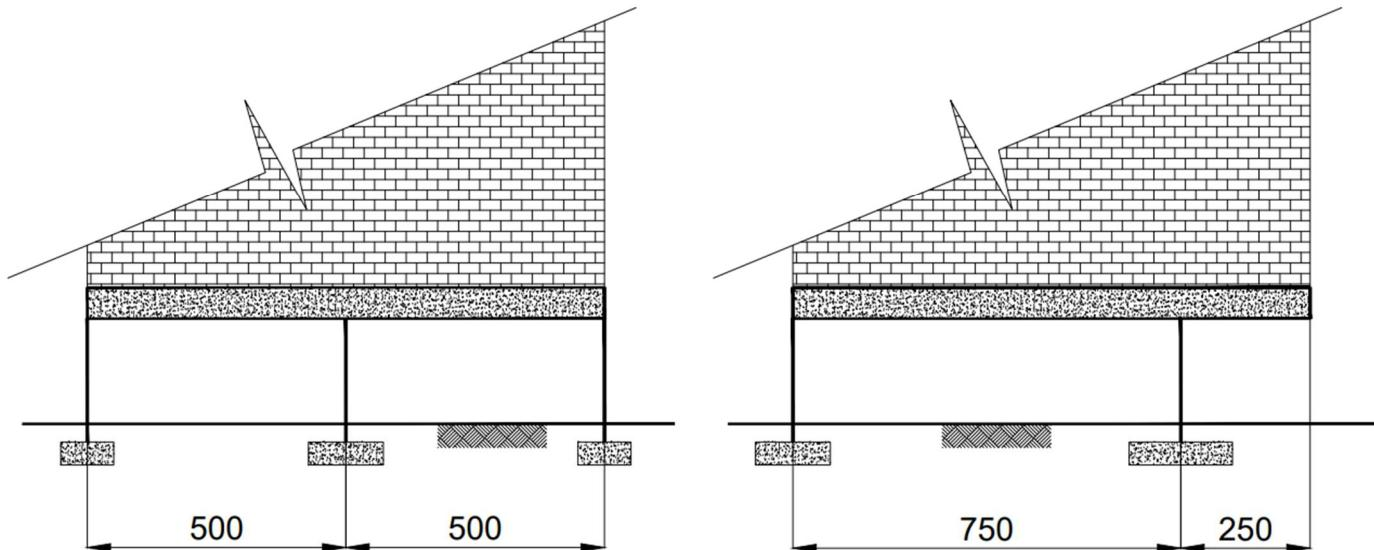
A viga receberá carga uniforme de 240 kN/m. O subsolo na região é formado por areia média, pouco argilosa, medianamente compacta a compacta, com nível d'água freático localizado a 1,50 m, e impenetrável a grande profundidade. Estudos do solo permitiram definir valores iniciais de alguns parâmetros, tais como:
