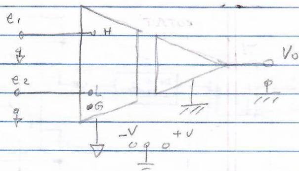
Uma aplicacao importante do AI isol é em eletronica médica, quando eletrodos aplicados ao corpo humano devem ser isolados de qualquer instrumento ou circuitos alimentados diretamente de rede C.A.
