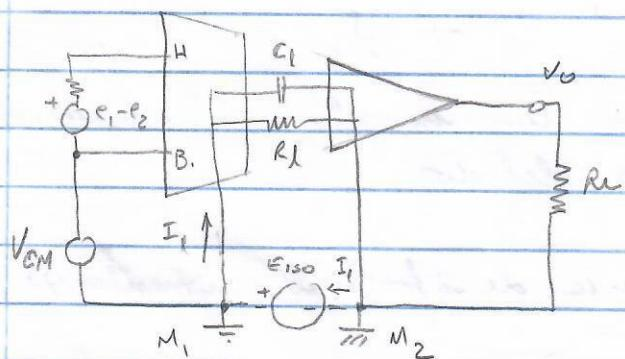
A barreira de isolacão não é infinita. Uma corrente de fuga flui através de uma impedância armada representada por  $R_f // C_f$ .
