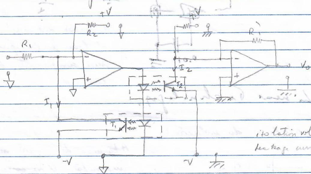
Amplificador de isolacão com acoplamento usando dois pares casados emissor/detector.
