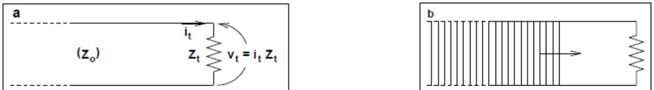
Figura 6 A linha de transmissão possui impedância  $Z_0$  e está terminada por uma carga puramente resistiva  $Z_t$ . Obviamente a Lei de Ohm deve ser respeitada e devemos ter  $V_t=i_t Z_t$ , onde  $V_t$  e  $i_t$  são, respectivamente, a tensão e a corrente total nos extremos da carga.
