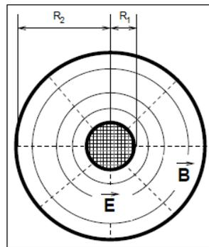
Figura 5 Um cabo coaxial é constituído de um condutor central de raio  $R_1$  envolvido por uma malha metálica de raio  $R_2$  que constitui o segundo condutor. Num cabo coaxial as linhas de força do campo elétrico são radiais e as linhas de campo magnético são circulares. Fazemos nossa análise, entretanto, para as tensões e correntes no cabo.
