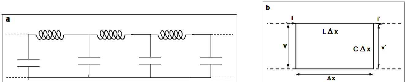
**Figura 4** Para a dedução da equação de onda, imaginamos que uma linha de transmissão se comporta como uma distribuição contínua de capacitores e indutores (a), da qual isolamos uma célula elementar de extensão  $\Delta x$  com indutância  $L\Delta x$  e capacitância  $C\Delta x$  (b).
