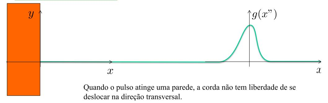
A solução da equação de onda deve levar isto em conta:
