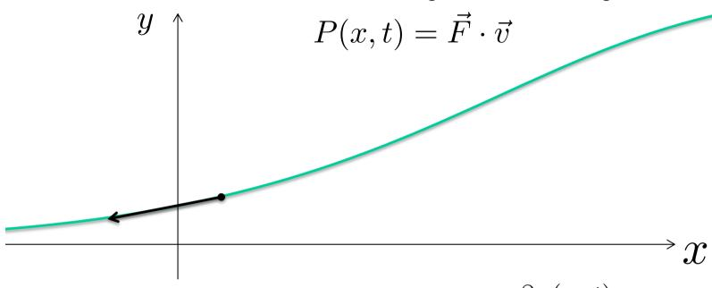
Velocidade: apenas componente transversal:  $\vec{v} = \frac{\partial y(x,t)}{\partial t}\hat{j}$
