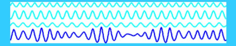
Ondas harmônicas contrapropagantes, ondas de mesma frequência:
