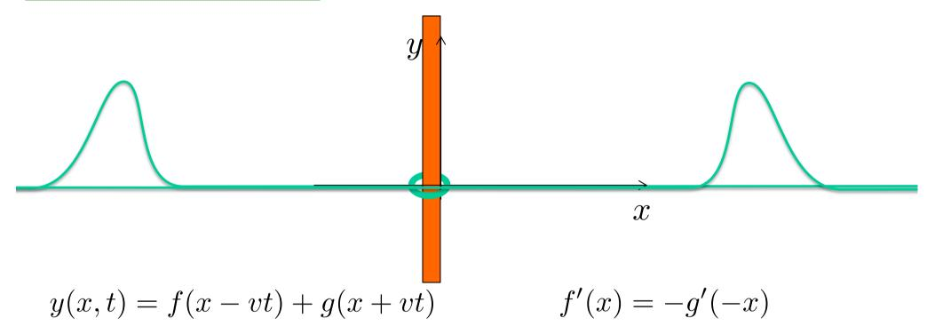
Se a derivada é uma função ímpar, a função primitiva é par em x!
