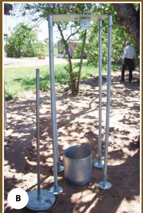
Figura 2. Exemplo demonstrativo de cilindro com solo (A) do aparato para introdução do cilindro no solo (B, C e D)
