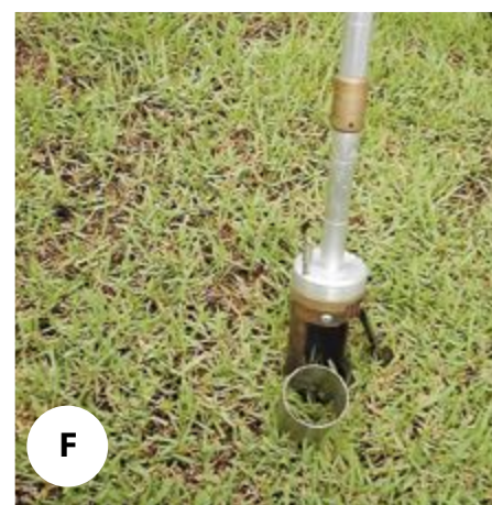
Figuras 3A, 3B, 3C, 3D, 3E e 3F. Amostrador volumétrico de Kopeck e procedimentos para coleta de amostra indeformada de solo
