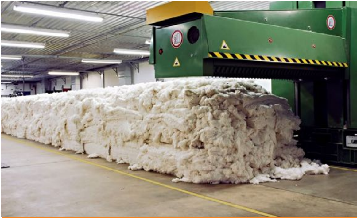
Figura 5. Linha de abertura dentro de uma fiação
