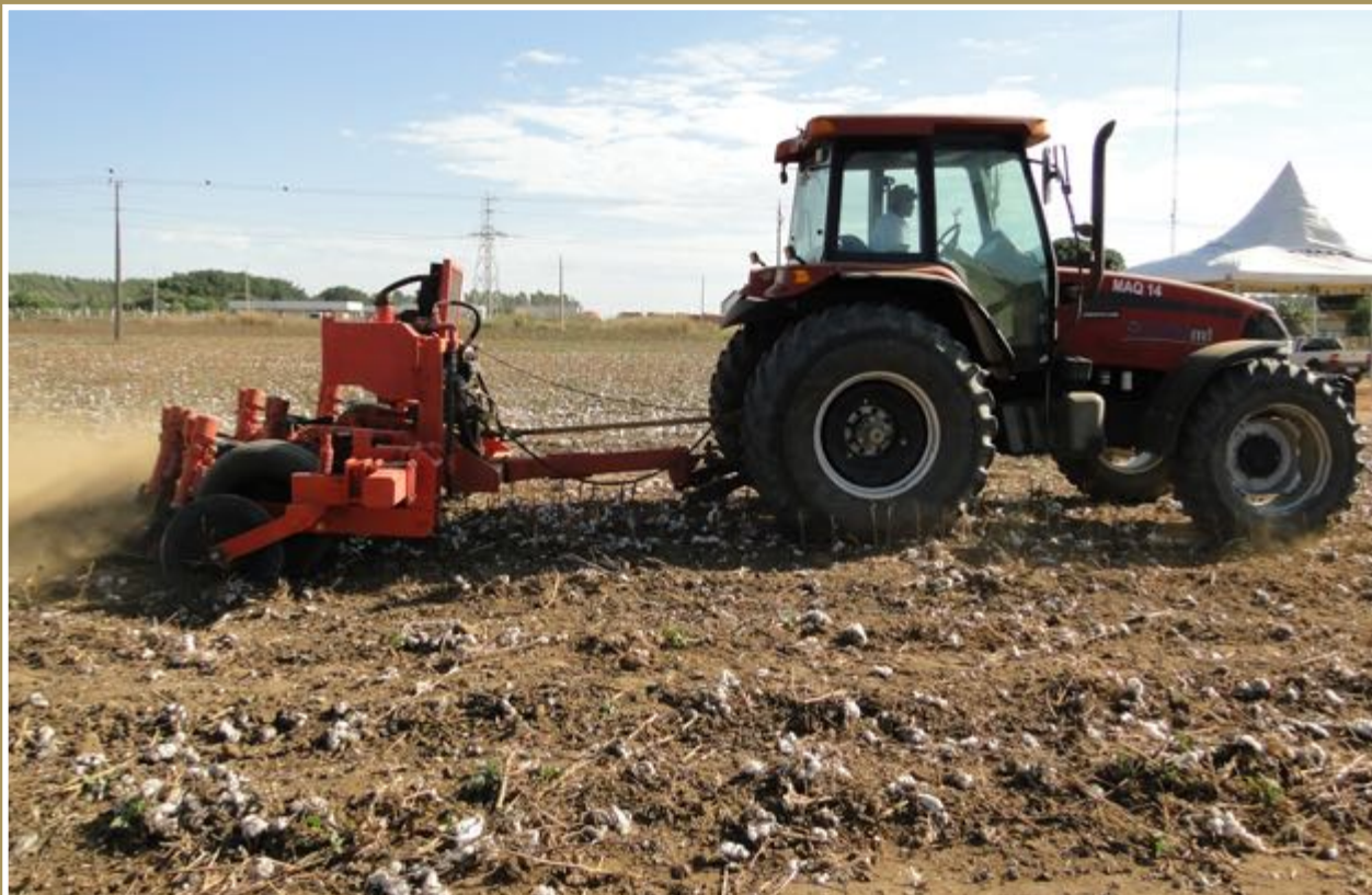
Figura 4. Cortador triturador de plantas acoplado à barra de tração do trator
