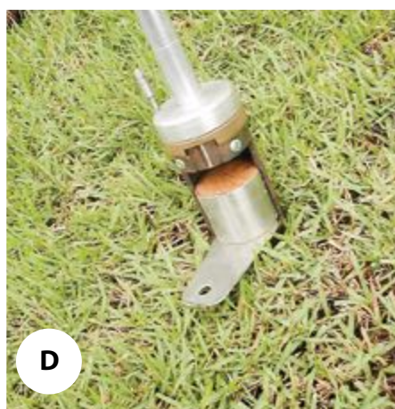
Figuras 3A, 3B, 3C, 3D, 3E e 3F. Amostrador volumétrico de Kopeck e procedimentos para coleta de amostra indeformada de solo
