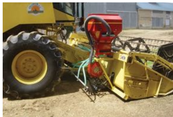
Figura 9. Semeadeira acoplada à plataforma de colheita para implantação das coberturas
