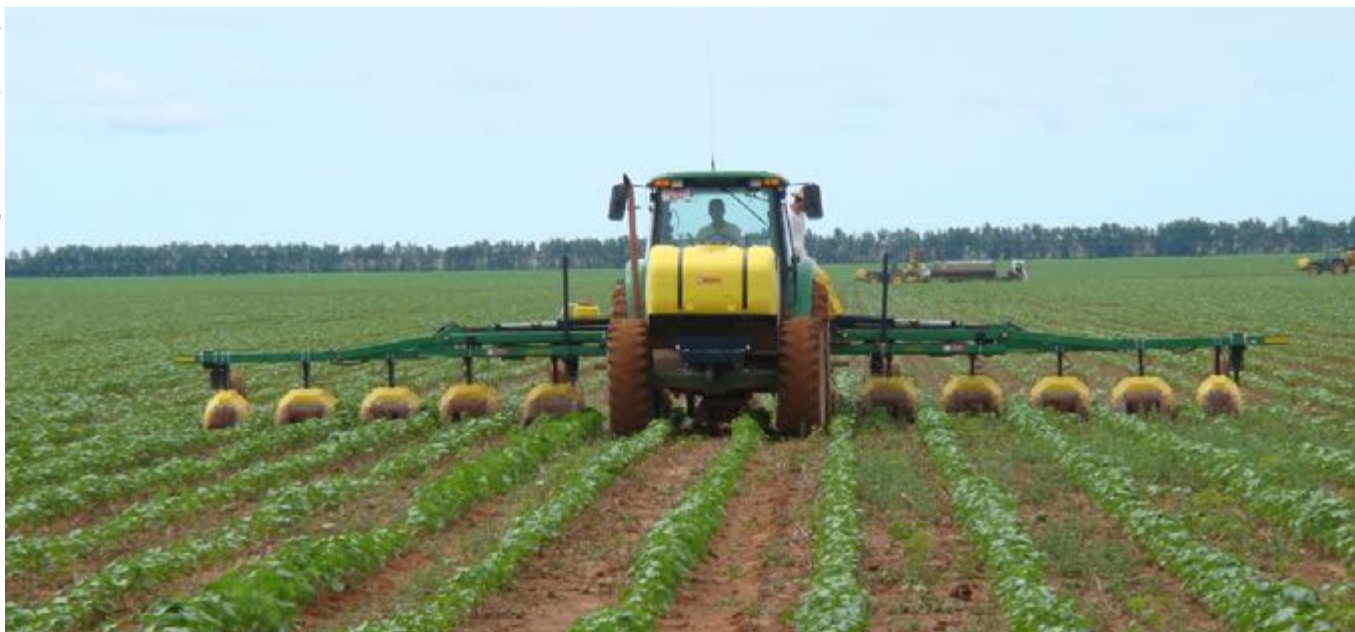
Figura 5. Equipamento para aplicação protegida de pós-emergente em jato dirigido
