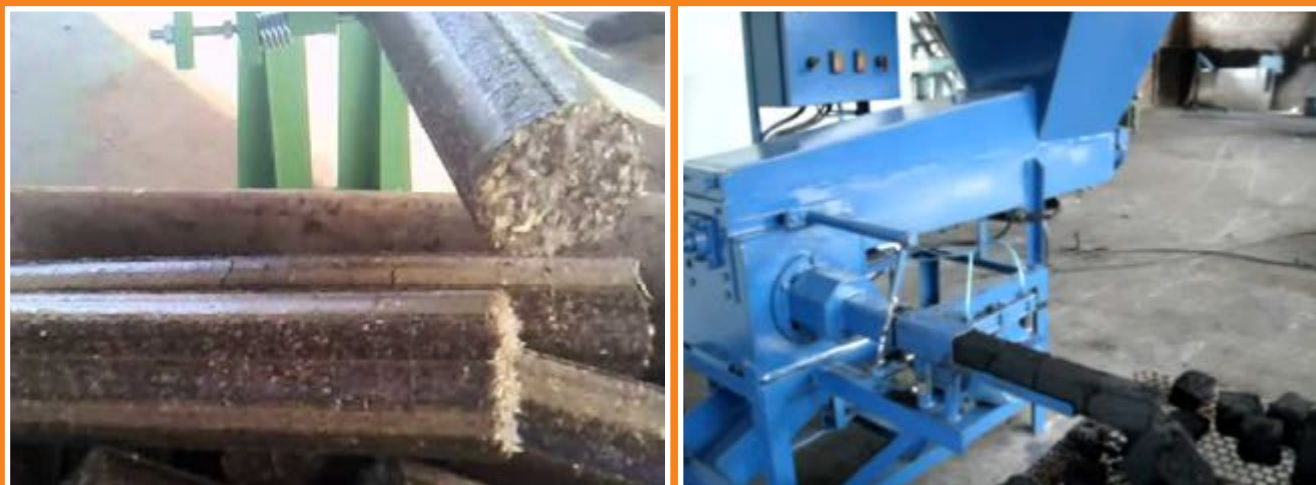
Figura 2. Prensa para fabricação de briquetes a partir de casquinhas de algodão ou de outros resíduos
