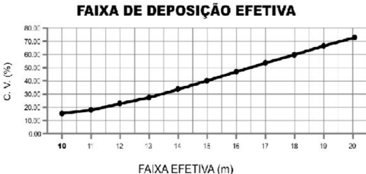
Figura 8. Coeficiente de variação de deposição em função da distância ao eixo de simetria da faixa aplicada
