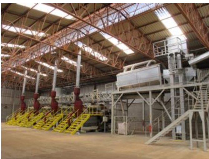
Figura 7. Prensa para extração de óleo bruto e produção de torta gorda instalada em uma fazenda
