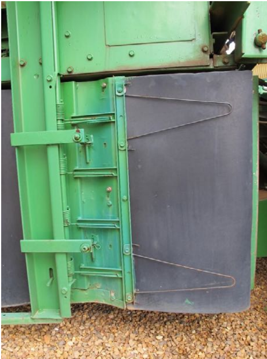
Figura 6. Placa de raspagem montada no tambor traseiro
