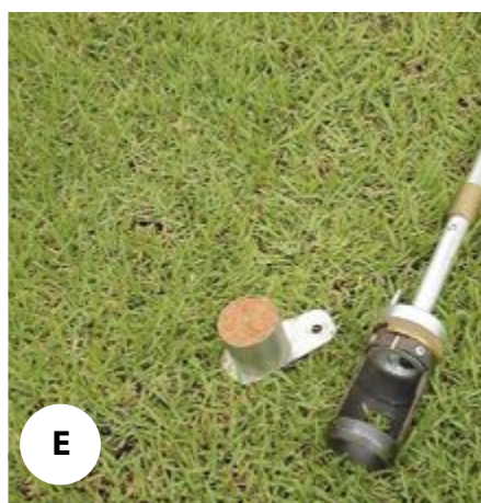
Figuras 3A, 3B, 3C, 3D, 3E e 3F. Amostrador volumétrico de Kopeck e procedimentos para coleta de amostra indeformada de solo
