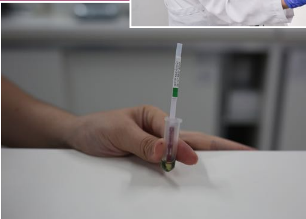
Figura 5. Teste de expressão de proteína com tira de fluxo lateral
