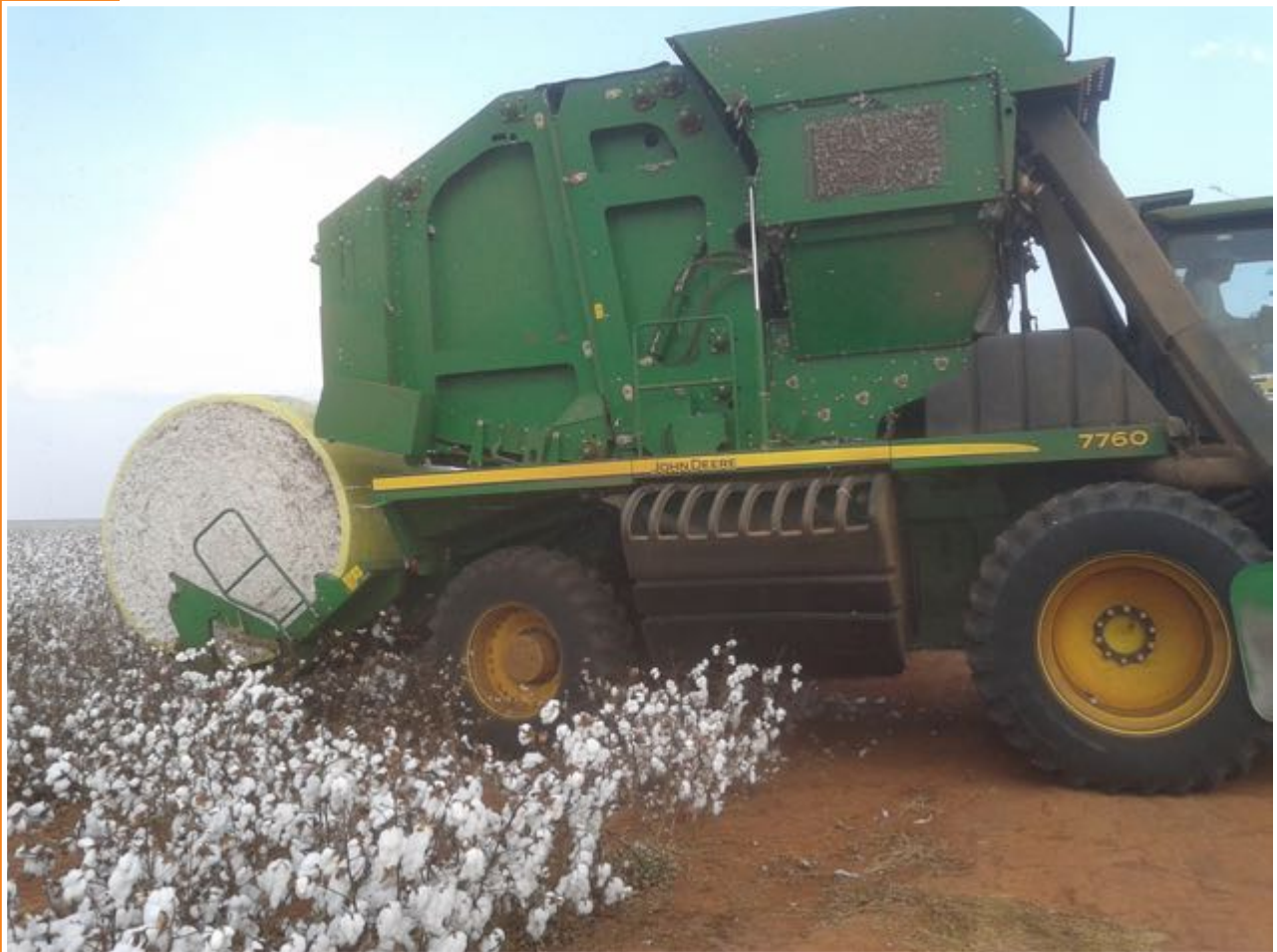
Figura 11. Módulo ejetado sobre o transportador na parte traseira da máquina
