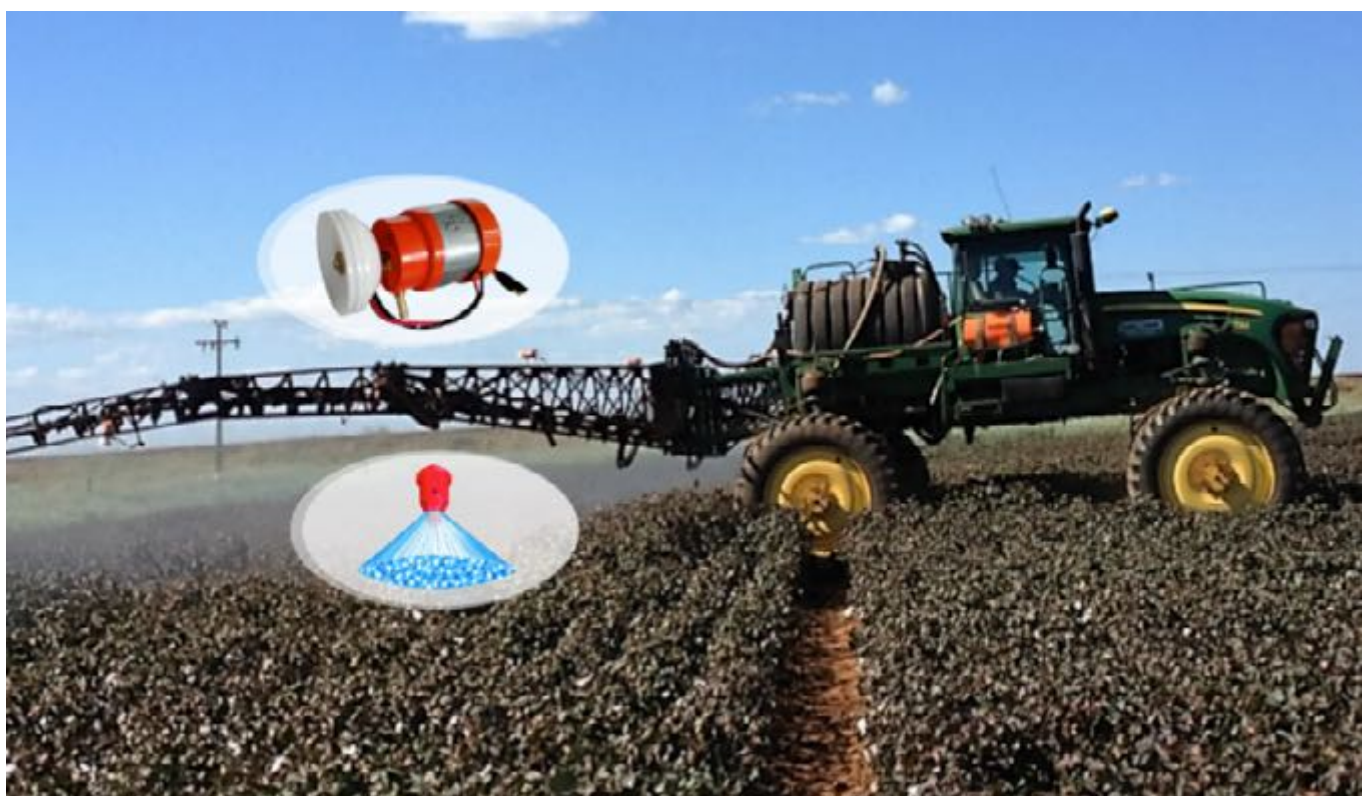
Figura 18. Turbotrator - modelo TT BVO Flex (aplicações em UBV e BVO®); volume de 1 a 5 litros por hectare (Centro Brasileiro de Bioaeronáutica: Manual de Operação e Manutenção do Turbotrator modelo TT BVO Flex)
