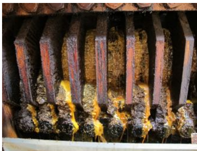
Figura 7. Prensa para extração de óleo bruto e produção de torta gorda instalada em uma fazenda
