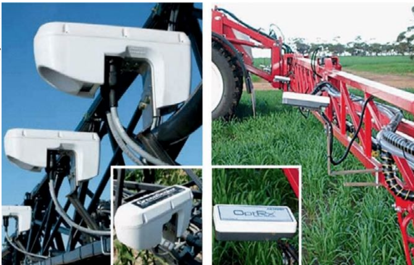
Figura 5. Sistema composto da Trimble usando os sensores GreenSeeker® e OptRx®
