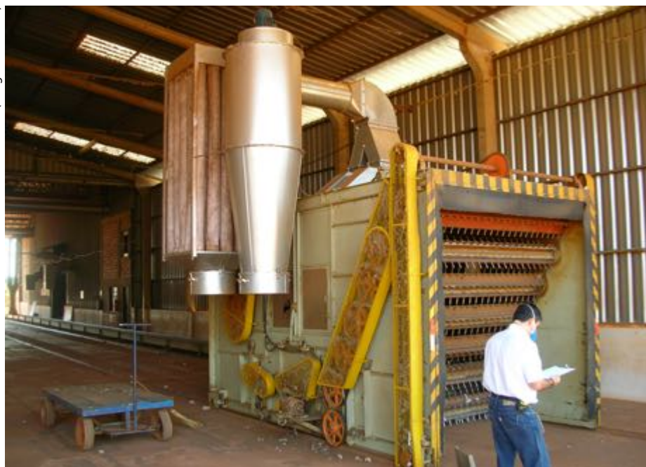
Figura 4. Sistema de catação de poeira no desmanchador móvel
