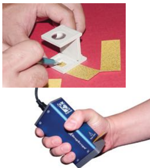
Figura 1. Leitor digital do sistema DropScope em substituição ao subjetivo método leitura visual
