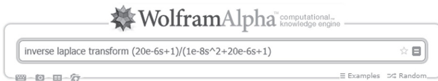
FIGURA 4.11 Circuito elétrico RLC: programação para obtenção da resposta ao impulso.
