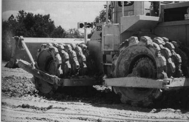
**FIGURA 1.51** A compactação de solos usados como fundações e estradas é realizada por pesados equipamentos como este rolo de pés de carneiro. As saliências (“pés de carneiro”) concentram a massa em pequenas áreas de contato, perfurando e amassando o solo solto e recém graduado para uma densidade ótima. (Foto cortesia de R. Weil)
