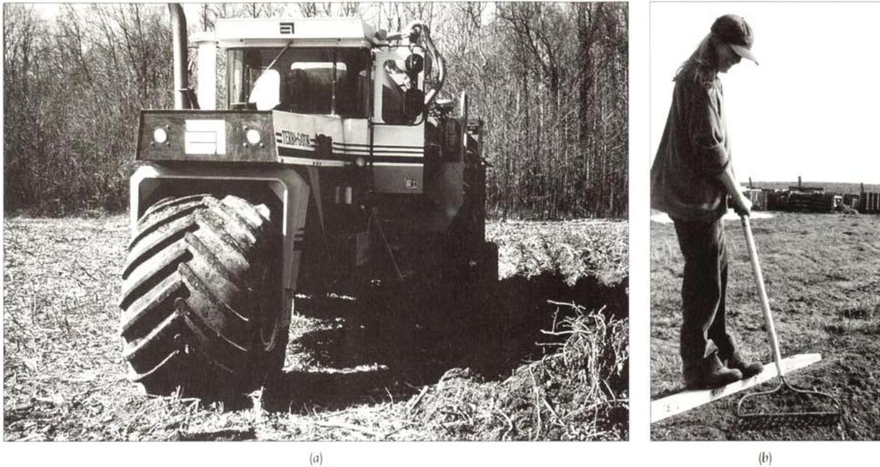
**FIGURA 1.42** Um método para reduzir a compactação do solo é distribuir o peso aplicado sobre uma maior área de superfície do solo. Os exemplos são o uso de máquinas pesadas com pneus extralargos para aplicação de corretivos no solo (*esquerda*) e permanecendo em pé sobre uma tábua de madeira enquanto prepara os canteiros do jardim no início da primavera (*direita*). (Fotos cortesia de R. Weil).
