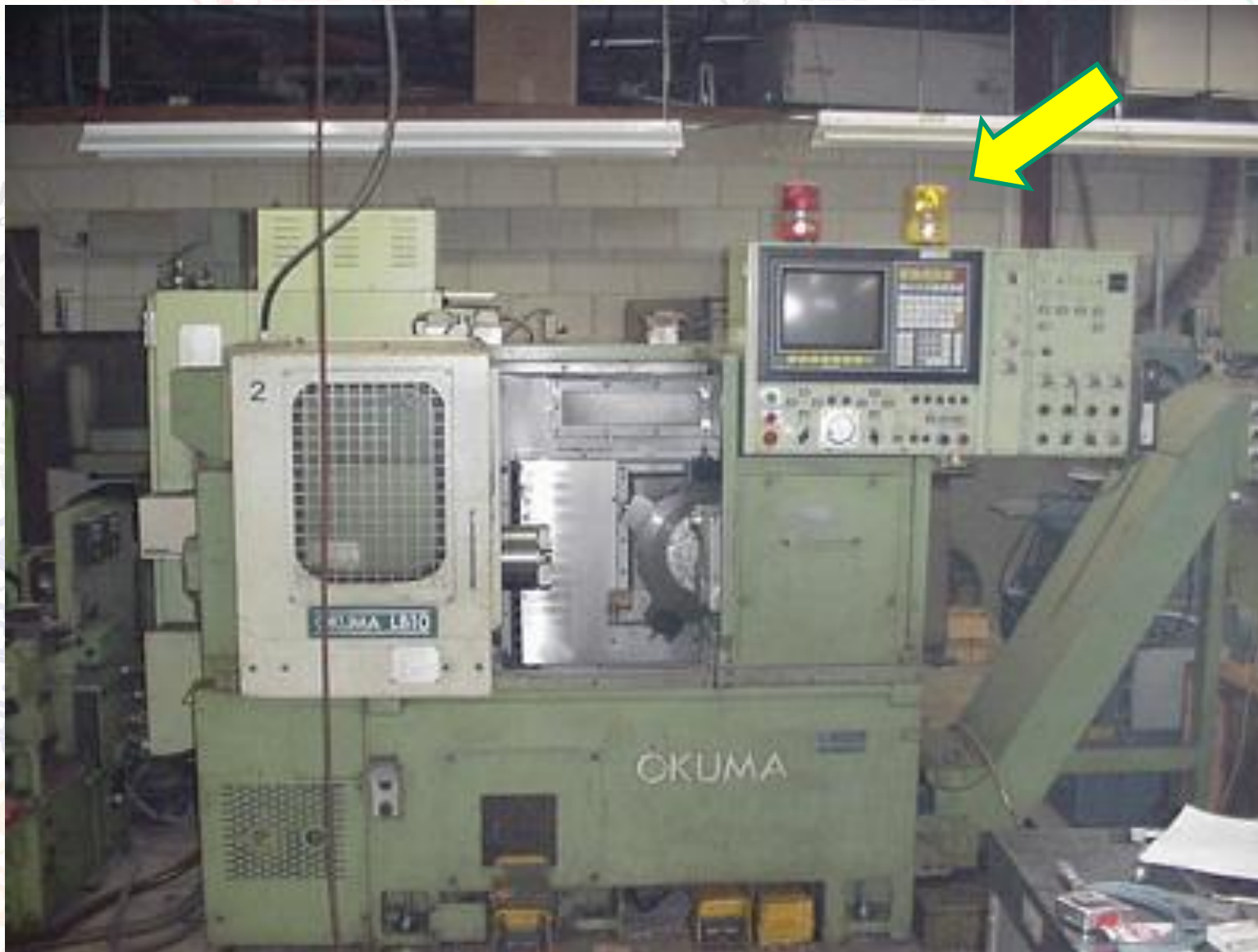
1985, Torno Okuma CNC 2-Axis, 12 posições do castelo, carregamento robótico.
