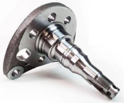
são sujeitos a apenas a flexão devido aos apoios, e por isso Não transmitem torque. Um eixo não é torcido, apenas fleto.
