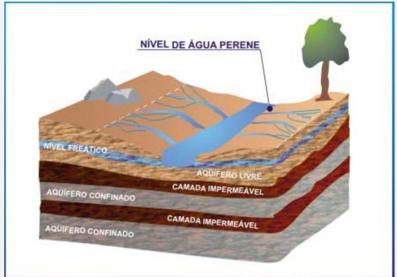
Tipos de aquíferos segundo a sua localização (BORGHETTI et al, 2004 apud ABAS, 2006)
