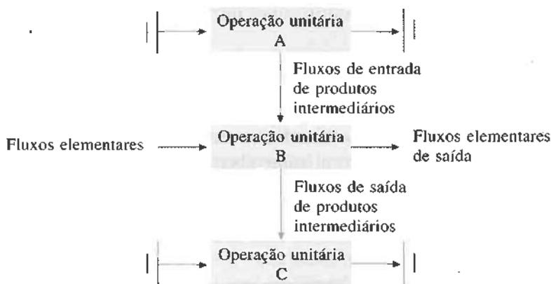
Figura 10.2 – Exemplo de uma operação unitária num sistema operativo (produção, processo ou serviço)
