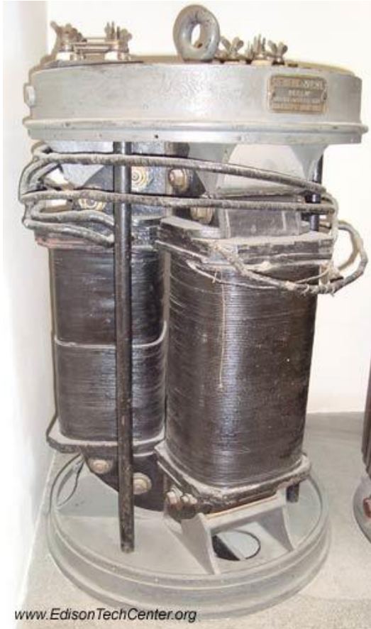
1891, Transformador trifásico (núcleo circular) Siemens and Halske company 5.7 kVA 1000/100 V
