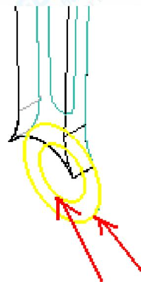
Clique no comando **Cut**. Clique sobre o plano gerado pela face da haste da biela, conforme indicado na figura.
