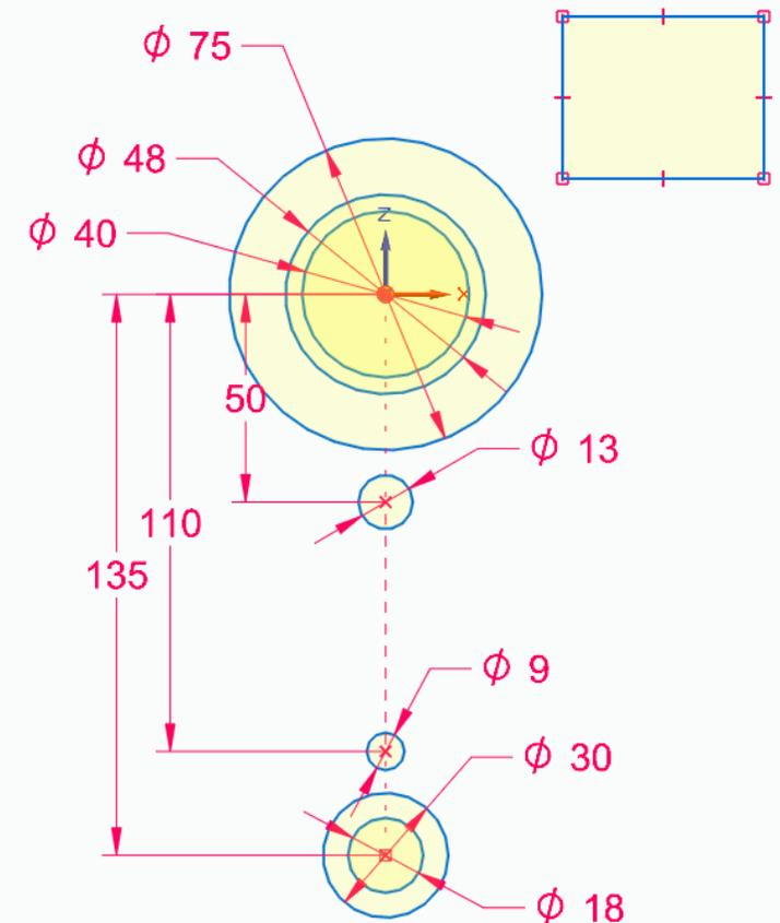
Com o comando **Smart Dimension** puxe cotas de dois dos lados do retângulo e edite seus valores conforme mostrado na figura. Use o comando **Conect** para conectar o ponto médio de uma das linhas horizontais (indicador **midpoint**) do retângulo à linha de referência vertical (indicador **point on element**).
