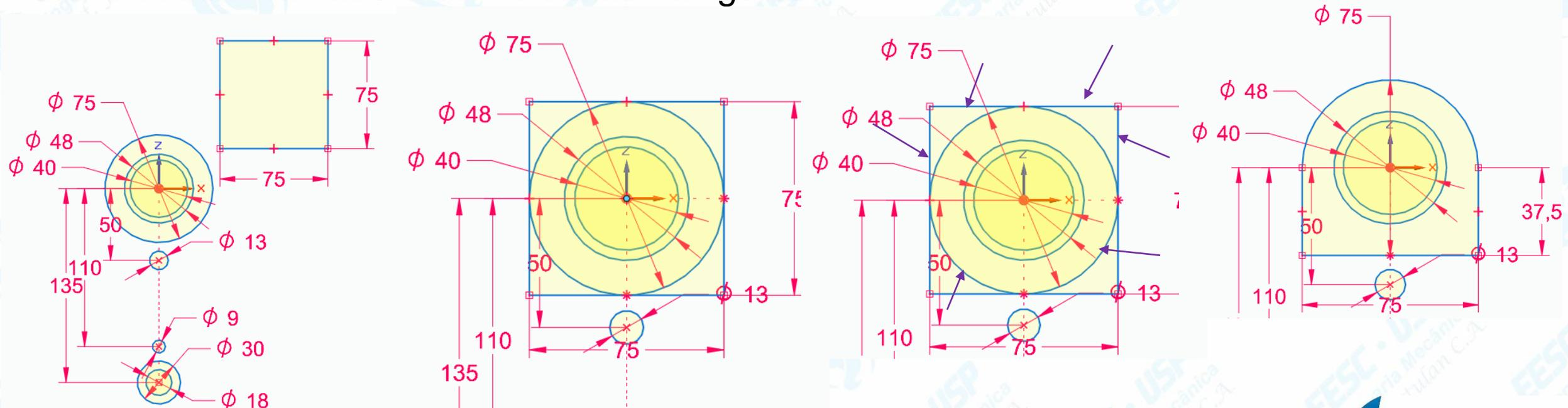
Com o comando **Line**, faça uma linha com ponto inicial na linha horizontal do desenho (indicador **point on element**) e ponto final na circunferência de diâmetro 30 mm. Clique apenas quando aparecer unicamente o indicador **point on element**.
