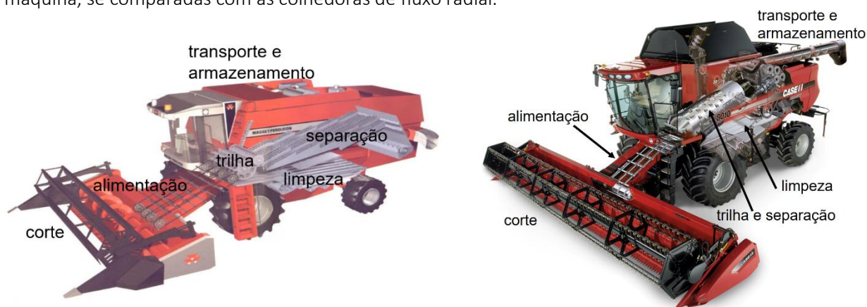
Figura 9. Colhedora com trilha de fluxo radial (esquerda) e de fluxo axial (direita) mostrando os sistemas internos da máquina
