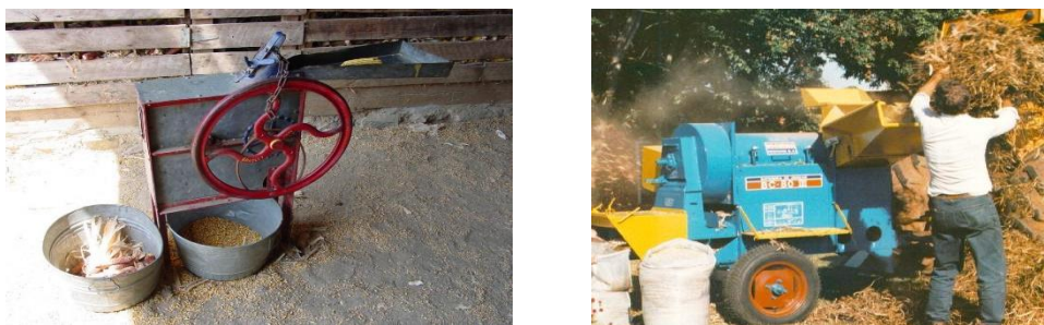
Figura 2. Debulhadora de milho, de acionamento manual (esquerda) e trilhadora estacionária acionada pela TDP do trator, trilhando feijão (direita)
