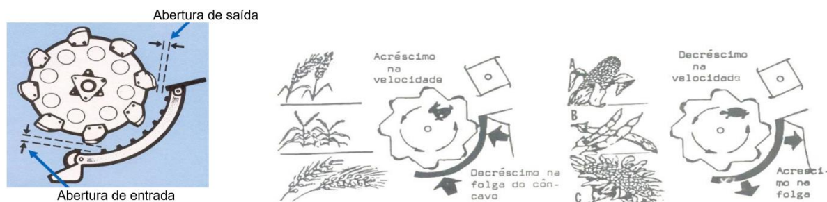
Figura 15 – Princípios básicos de regulagens no sistema de trilha – aberturas e rotações
