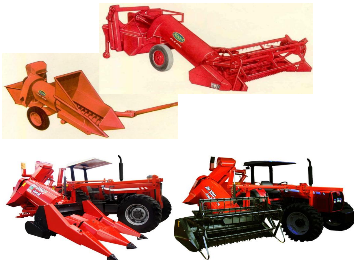
Figura 7. Colhedora combinada de grãos semi montada com plataforma despigadora, acionada pela TDP (esquerda); colhedora combinada de grãos semi montada com plataforma segadora e acionada pela TDP (direita).
