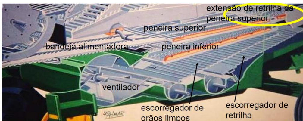
Figura 11. Sistema de limpeza com a bandeja de alimentação, as duas peneiras, ventilador e a extensão de retilha da peneira superior
