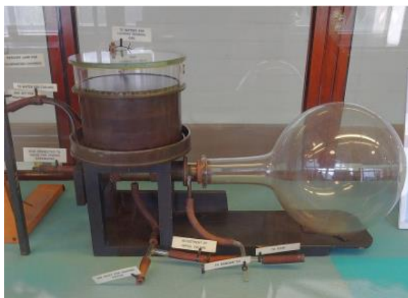
Figura 5 - Projeto e desenho da Câmara de Nuvens projetada por C.T.R. Wilson.
