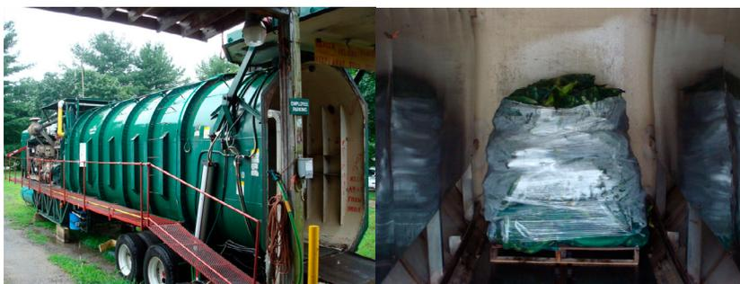
Figura 1 - Resfriador a vácuo móvel utilizado para pré-resfriamento de milho.
