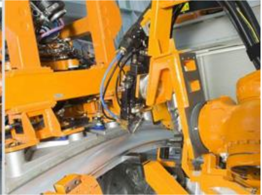
Processo de soldagem contínua a laser do teto na produção.
