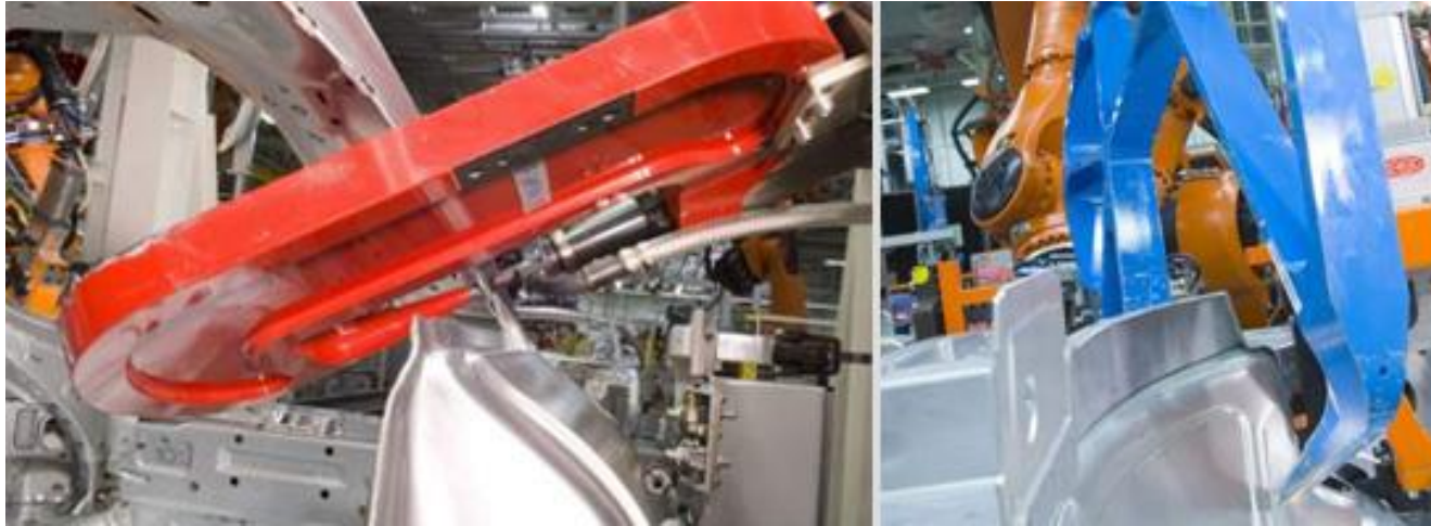
Processo de colocação de rebites estampados na produção
