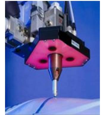
Aplicação de cola para colagem da estrutura.
