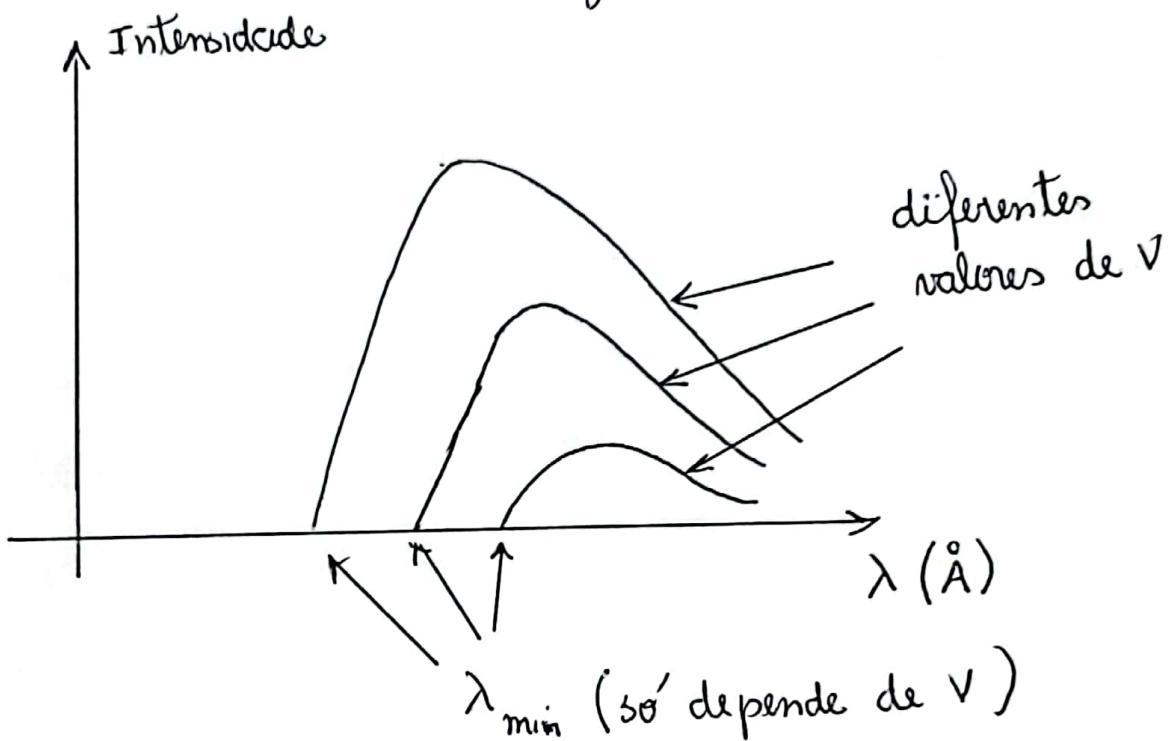
A forma das curvas acima dependem da tensão de aceleração  $V$  aplicada entre o catodo e o ânodo e, em menor grau, do material do ânodo.
