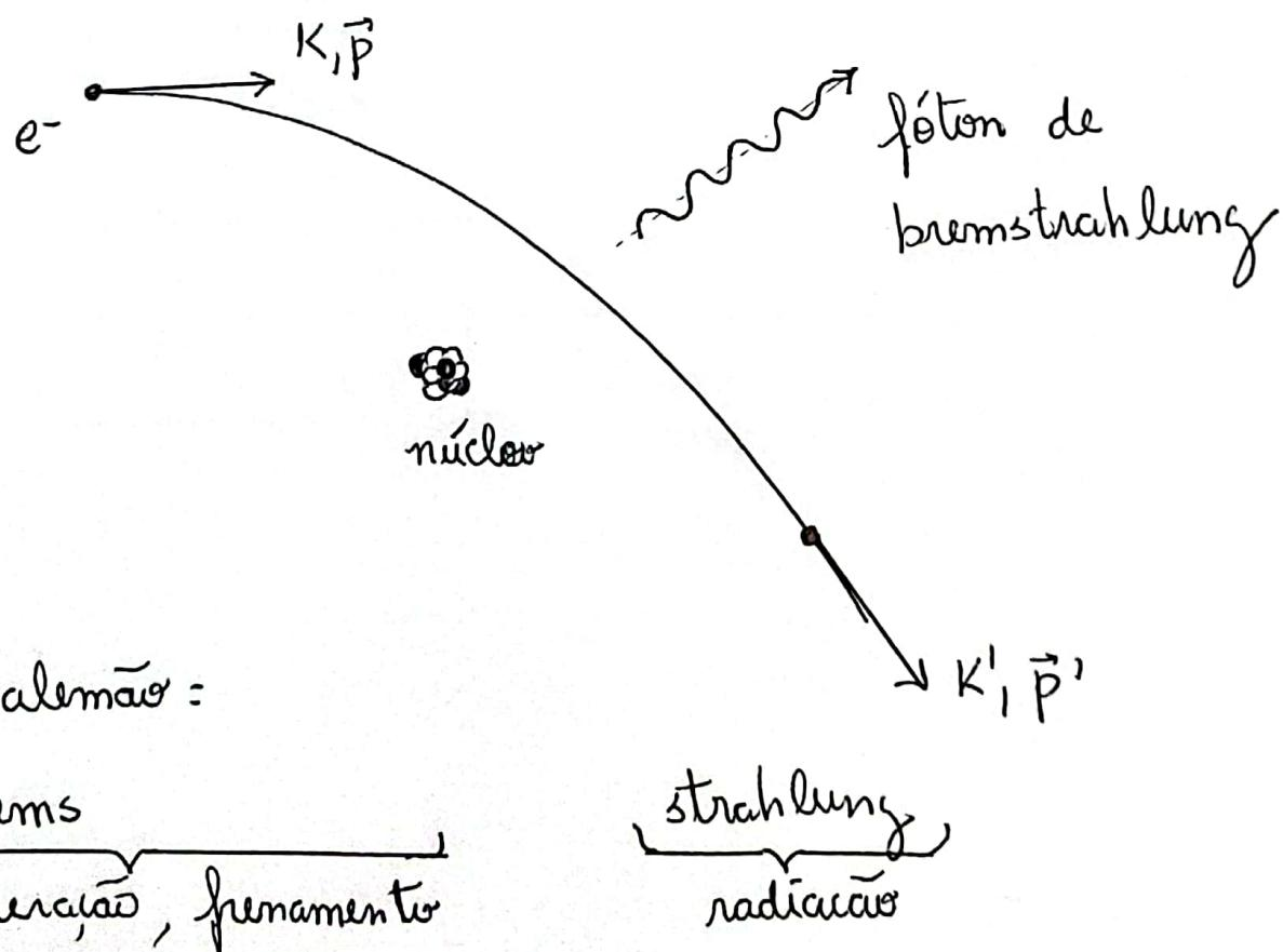
A energia cinética típica dos elétrons no tubo de raios-X está na faixa de keV, ou seja, muito menor que a energia de repouso dos núcleos atômicos. Nessas condições podemos desprezar a energia de recaí do núcleo atômico. Portanto, a energia do fóton emitido deve satisfazer
