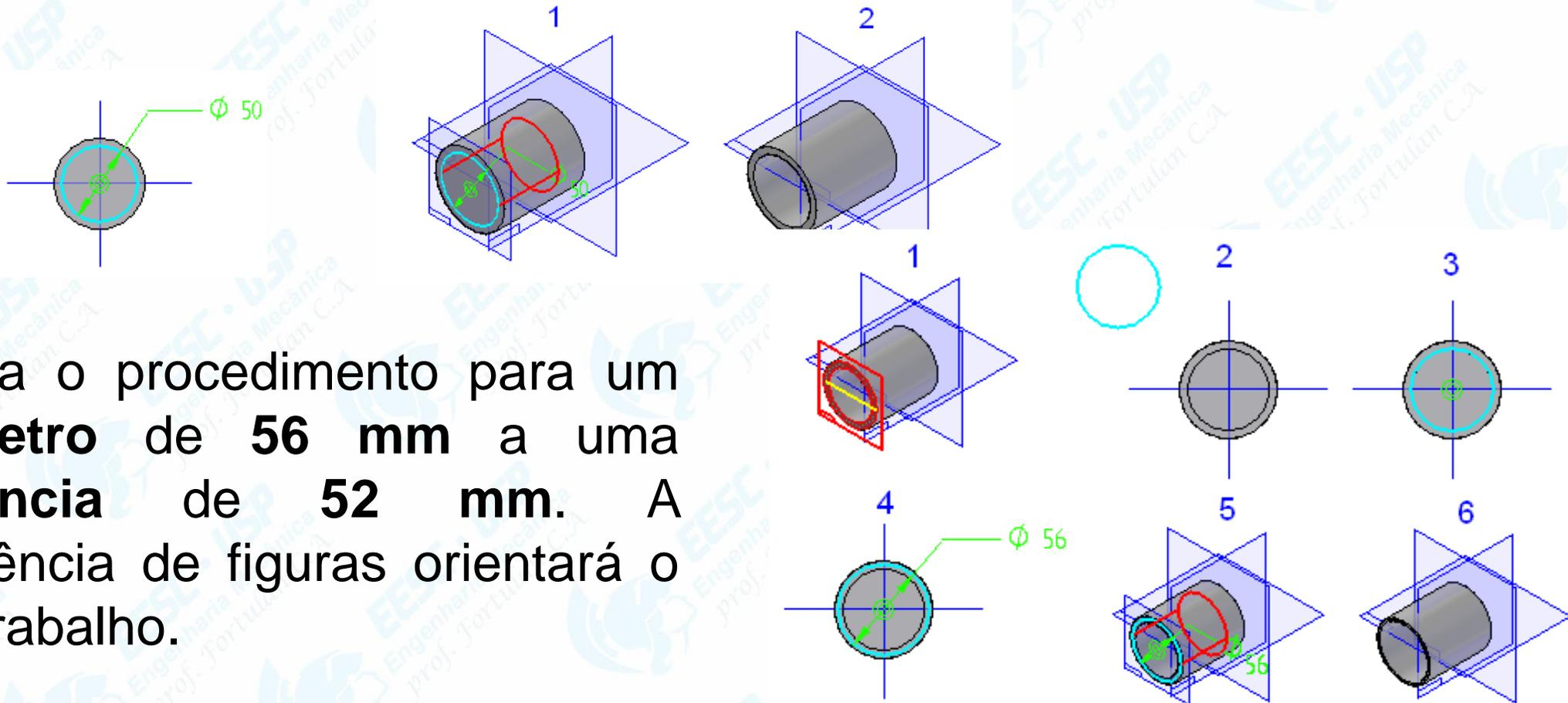
Repita o procedimento para um diâmetro de **56 mm** a uma distância de **52 mm**. A sequência de figuras orientará o seu trabalho.
