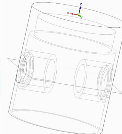
Fazendo os canais externos → clique no comando **Revolved/Cut**, clique no plano de referência lateral. Com o comando **Line** (**Home-Draw**), desenhe uma linha reta vertical conforme mostrado na figura, com o comando **Rectangle by two points**, crie um retângulo com ponto inicial em uma das extremidades da linha que você criou (Siga a orientação da figura). Repita o mesmo procedimento na outra extremidade da linha. Clique no comando **Trim** e clique sobre as linhas indicadas na figura.
