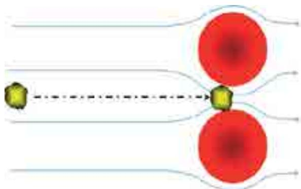
**Figura 1** – Mecanismo de filtração de partículas por restrição
