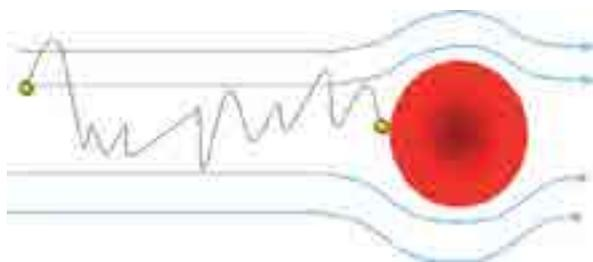
Figura 4 – Mecanismo de filtração de partículas por difusão
