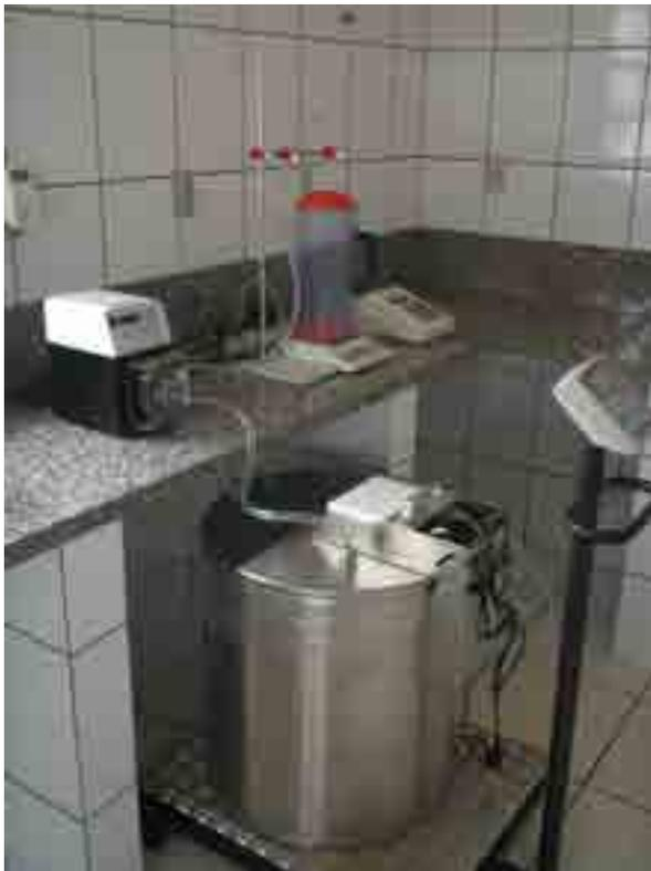
Foto 5 – Sistema automatizado de diluição do sêmen
