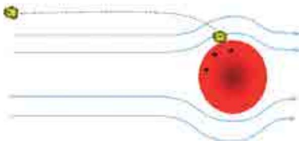
Figura 5 – Mecanismo de filtração de partículas por eletrostática
