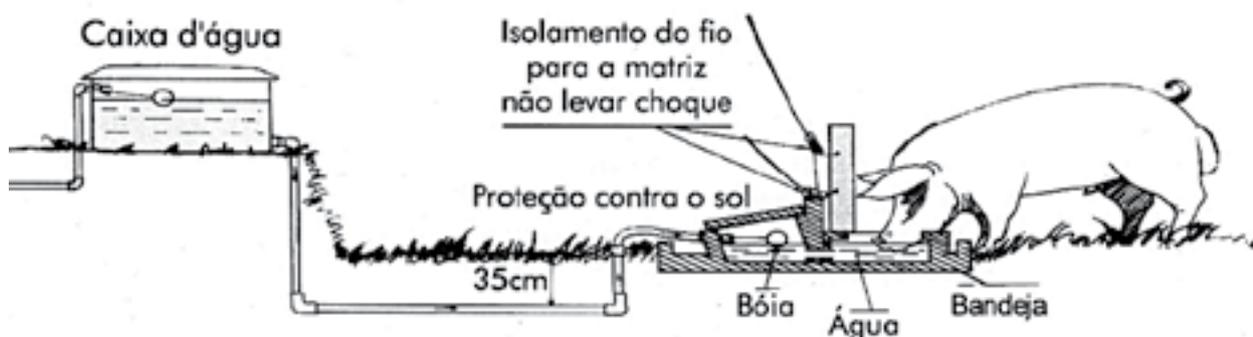
Figura 1 - Bebedouro vasocomunicante
