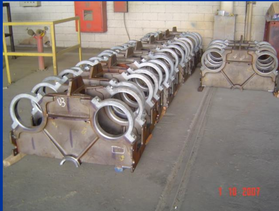
Conjunto de Truques Motrizes e Movidos durante fabricação
