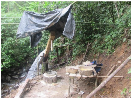
Foto 6: Monjolo para produção de farinha de milho na Cachoeira do quilombo Terra Seca (out/2014). Foto: Nilce Pontes Pereira.
