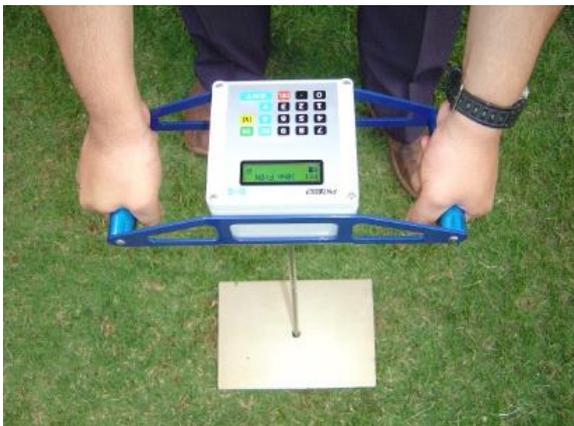
Penetrômetro geo-referenciado PNT-2000
