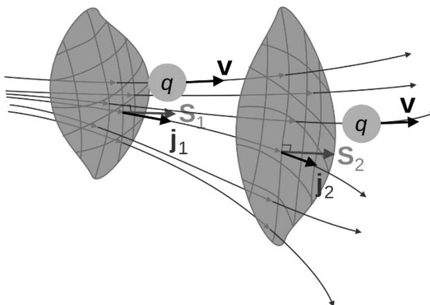
Figura 2 - A relação entre o movimento de cargas elétricas e a geração de uma corrente elétrica.
