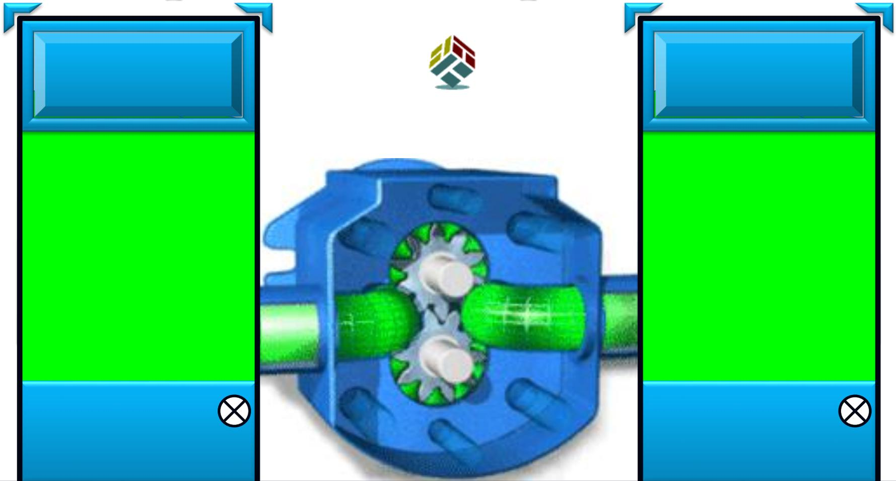
O par de engrenagens que rodam no interior de um compartimento estreito. O óleo é colocado de um lado do compartimento e transportado em torno da área exterior entre os dentes de engrenagem e para fora do ponto de descarga no lado oposto.
