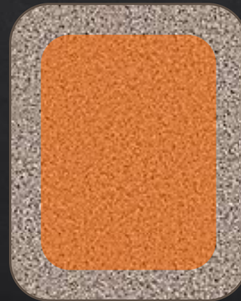
Resfriamento do concreto das bordas para o centro (baixa condutividade)
