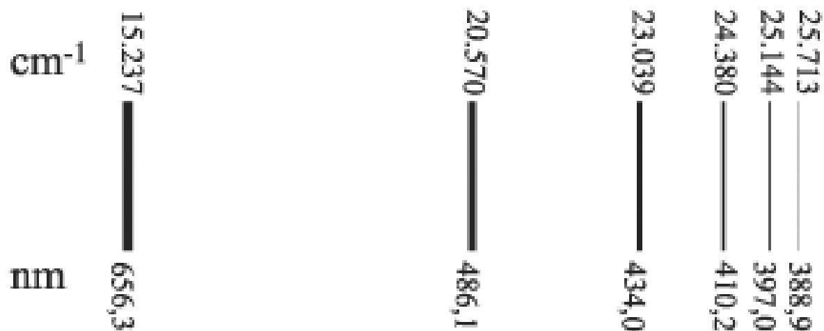
Figura 1. Esquema do espectro de hidrogênio mostrando as seis primeiras linhas da série de Balmer, estando indicado na parte superior o número de onda ( \text{cm}^{-1} ) e na parte inferior o comprimento de onda (nm)
