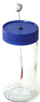
**1** - Faça um furo na tampa do vidro com a mesma espessura do arame. Dobre-o na forma de um gancho, fixe-o na tampa com adesivo epóxi e espere a cola secar. Corte duas tiras finas de papel alumínio de 3 cm de comprimento e prenda-as com o fio cobre. Depois que a cola estiver seca, coloque as tiras de papel alumínio no gancho. Tampe o vidro. Por último, encape uma bola de isopor com papel alumínio e fixe-a no arame.
