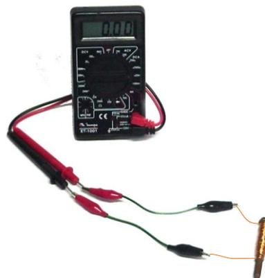
**3** - Passe o ímã sobre o prego, fazendo um movimento de ida e volta sem encostá-lo no fio de cobre. Observe o visor do amperímetro.
