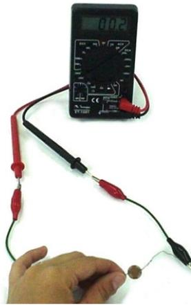
1 - Monte o circuito como mostra a foto. O ohmímetro deverá estar em uma escala ligeiramente maior que  $100K\ \Omega$ . Em seguida meça o valor da resistência do LDR, quando ele estiver completamente iluminado.
