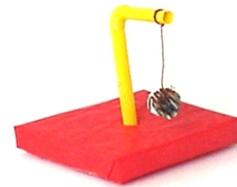
**1** - Dobre um canudo de modo que ele forme um L e fixe-o no isopor. Amarre uma linha na extremidade do canudo e, em seguida, cole com fita adesiva um disco de folha de alumínio na ponta da linha.
