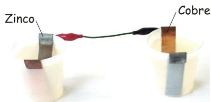
**3** - Ligue em série uma chapa de zinco, 1 led e uma chapa de cobre, com os jacarés, como mostra a foto. Observe o led.
