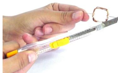
**2** - Construa 2 suportes (com fio de cobre de 1,5 mm<sup>2</sup>) para a bobina. Raspe o local, onde a bobina será apoiada. Em seguida, fixe os anteparos nas laterais da caixa de fósforos.
