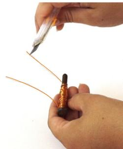
1 - Enrole em torno do prego aproximadamente 400 voltas de fio de cobre n.º 37, deixando 2 pontas. Remova, com o auxílio de um estilete 1 cm de verniz de cada ponta.
