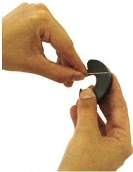
**1** - Faça uma marca em uma das pontas da agulha. Depois magnetize a agulha, passando o ímã ao longo dela por alguns minutos.
