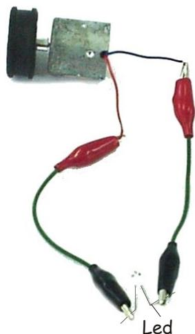
**1** - Fixe a roda no eixo do motor. Em seguida, conecte nele o led com os jacarés, como mostra a foto ao lado.
