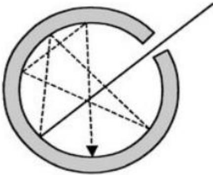
Corpo ideal que absorve toda a radiação e não reflete nada, a radiação vinda do exterior entre na cavidade e é refletida várias vezes na parede até ser absorvida totalmente.
