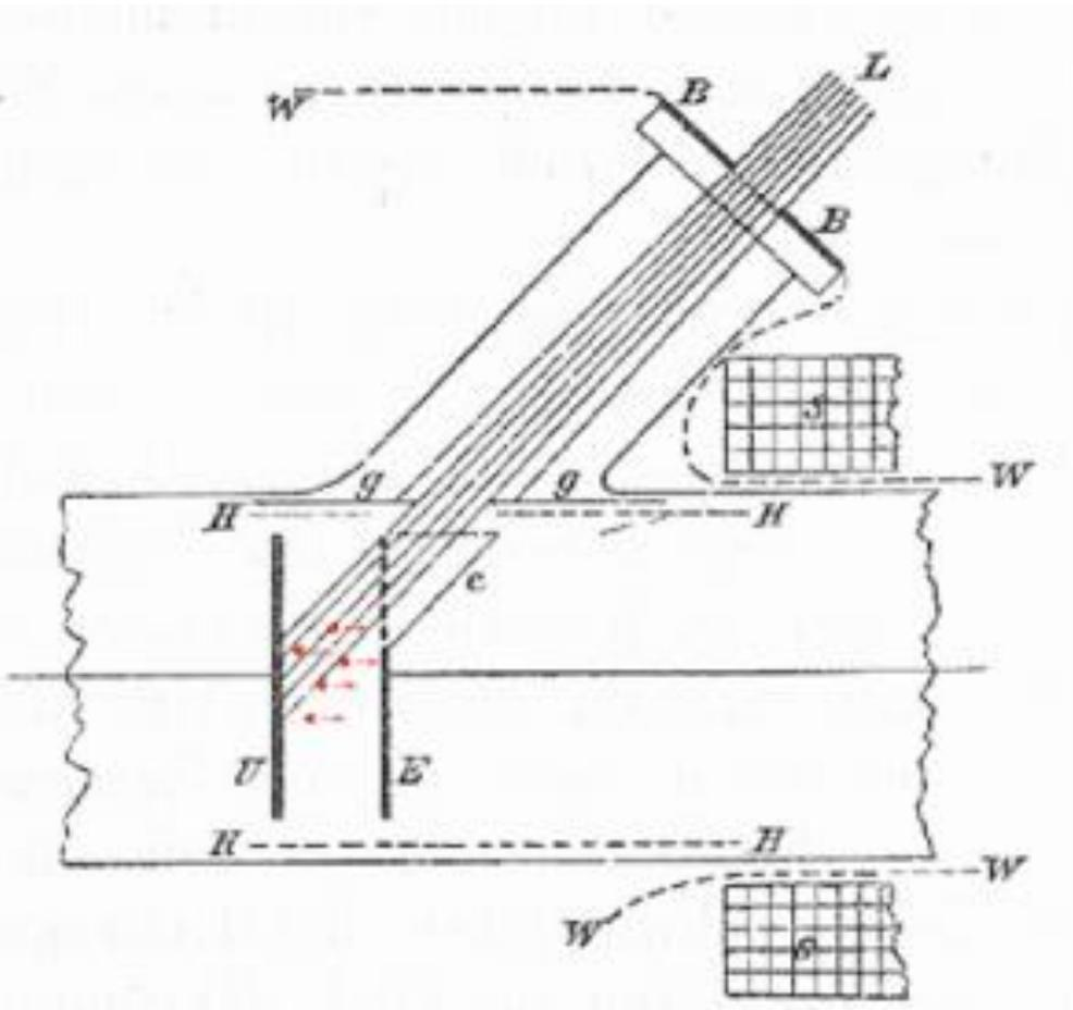
O experimento mede a corrente gerada entre os eletrodos e a energia cinética dos elétrons (recém descobertos - 1897)
