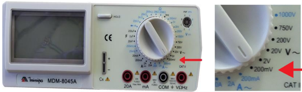
Modo de medida Potencial Elétrico Alternado (200mV ~)
