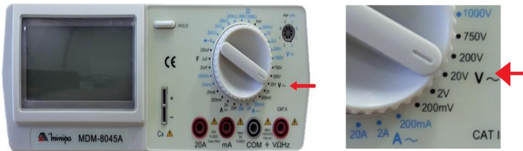
Modo de medida Potencial Elétrico Alternado (20 V ~)
