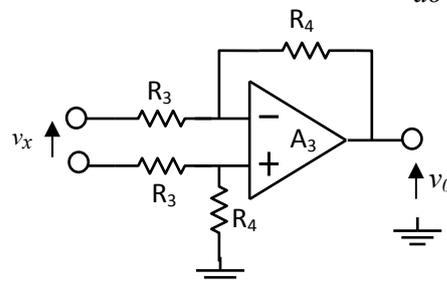
$$v_0 = -\frac{R_4}{R_3} \cdot v_x$$
