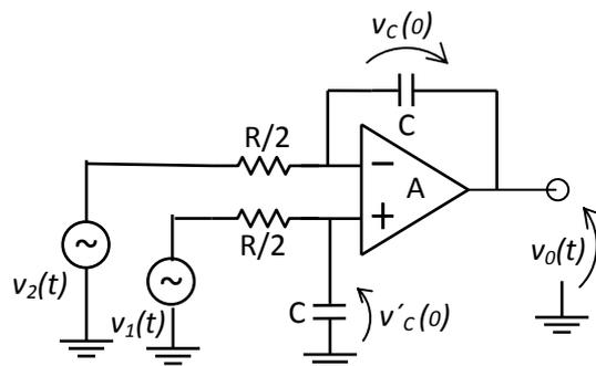
em que :  $v_0(t) = v_0(0) + \frac{2}{RC} \int [v_1(t) - v_2(t)] dt$
