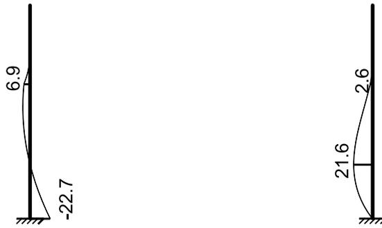
**Verificação das tensões de flexão no perfil:**
