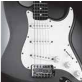
Figura 23.6 (a) Em guitarras elétricas, a vibração de uma corda magnetizada produz uma FEM sobre a bobina de captação. (b) Os captadores (círculos sob as cordas metálicas) dessa guitarra elétrica podem detectar as vibrações das cordas e enviar essa informação, por meio de um amplificador, para os alto-falantes. (Um interruptor na guitarra permite que o músico selecione qual conjunto de seis captadores será utilizado.)
