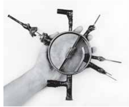
Figura 22.14 (a) Um ciclotron consiste em uma fonte de íon em P , dois “dês”, D_1 e D_2 , por onde uma diferença potencial alternada é aplicada, e um campo magnético uniforme. (b) O primeiro ciclotron, inventado por E. O. Lawrence e M. S. Livingston em 1934.
