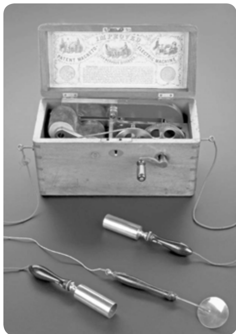
Figura 2 A Máquina magnetoelétrica de Davis e Kidder para desordens neurológicas. O paciente segurava um tubo de latão em cada mão enquanto o enfermeiro girava a manivela. O paciente recebia um choque da tensão gerada pelas bobinas giratórias na presença do campo magnético do grande ímã permanente na parte traseira da caixa.
