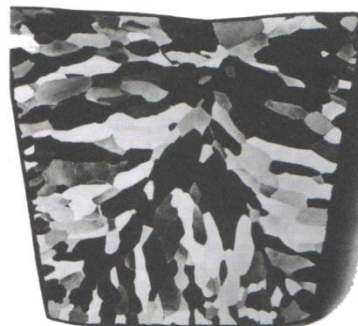
Um lingote de chumbo policristalino de elevada pureza.
