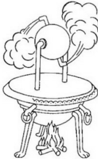
Figure 2: Aerolipa de Hierão de Alexandria
