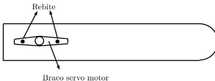
Figura 3.9: Braço do servomotor fixado ao suporte.
