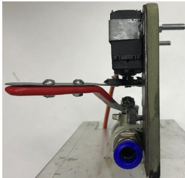
Figura 3.12: Estrutura de metal unida ao apoio de mdf naval através de parafusos e porcas.
