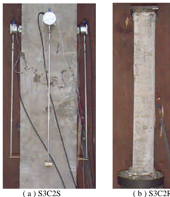
Foto 5.11 - Fotos da ruína dos modelos S3C2S e S3C2R
