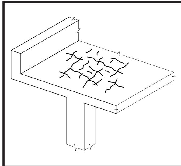
Figura 6. Fissuração típica de retração superficial ou dessecação superficial (CANOVAS, 1994).
