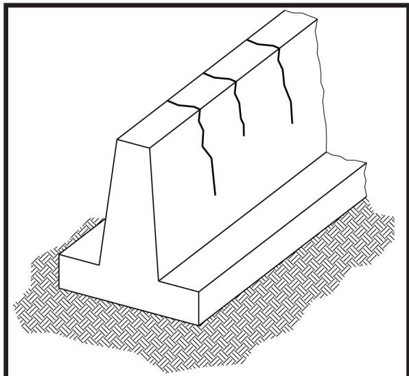
Figura 5. Fissuração típica de retração em muro.
